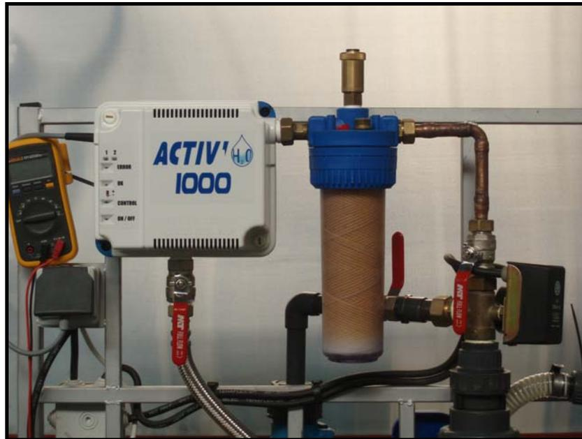
Figura 3.2.- Módulo de electro-peroxidación (ACTIV H2O 1000).
