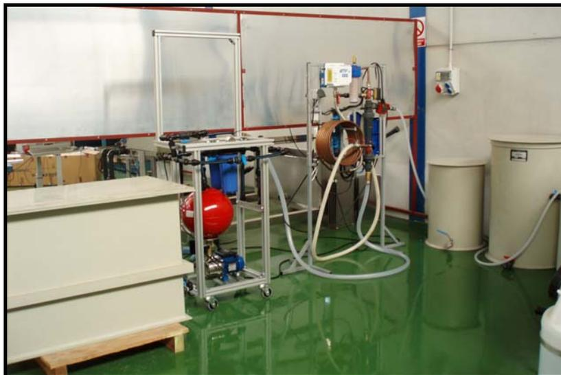
**Figura 3.1.-** *Unidad a escala piloto de electro-peroxidación.*
